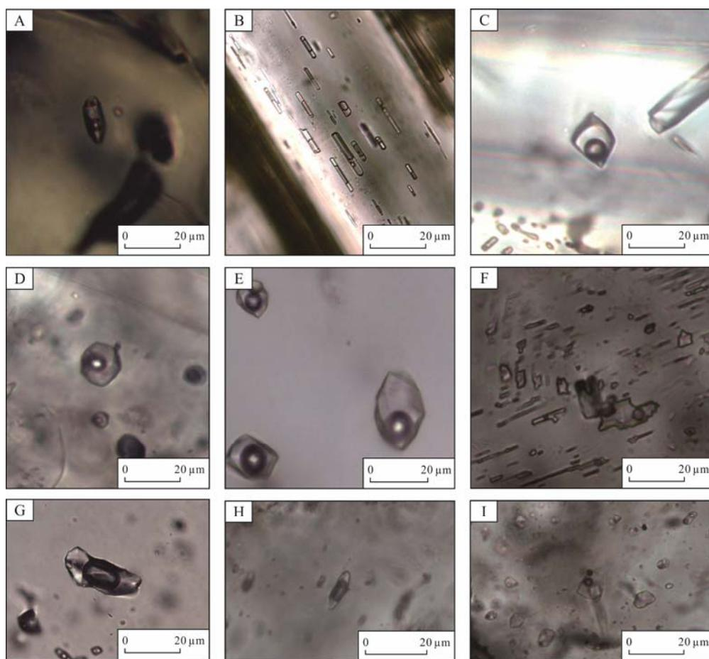
图 4 甲玛多金属矿床矽卡岩/角岩矿物中的流体包裹体
