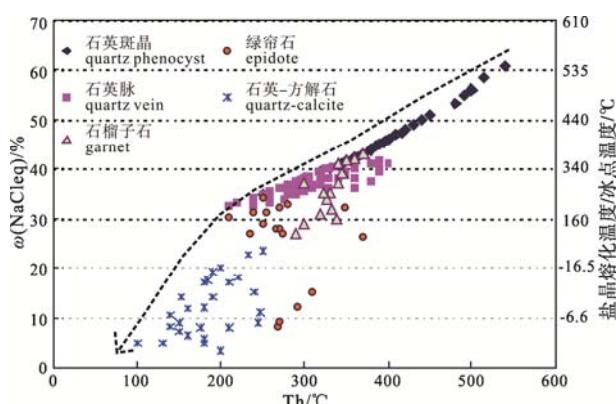
图 7 岩浆热液过渡阶段至石英硫化物阶段矿物流体包裹体均一温度-盐度-盐晶溶化温度/冰点温度演化图
