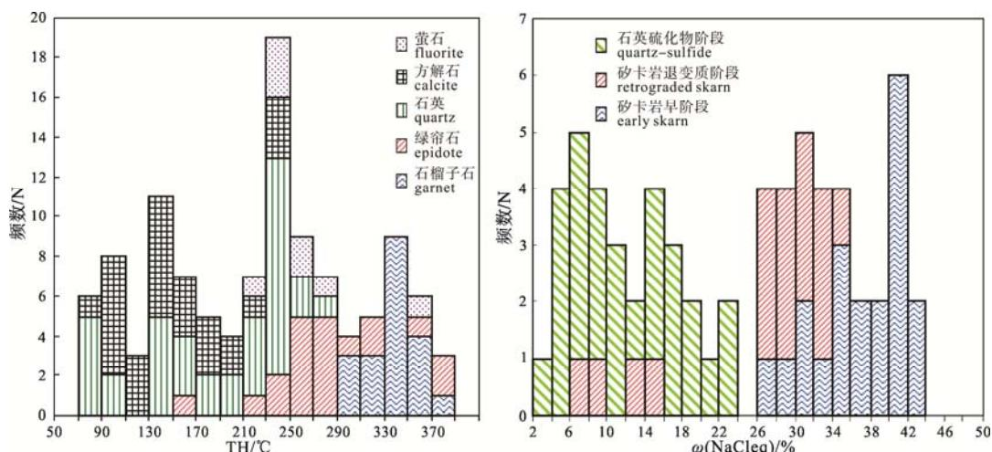
图 6 矿卡岩阶段矿物流体包裹体均一温度-盐度直方图
