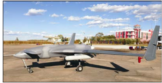
图 2 无人机航空磁/放综合测量样机
