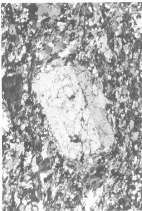
图版 I-2 推覆面附近糜棱岩中,长石残斑的边缘细粒化,及旋转拖尾现象。
