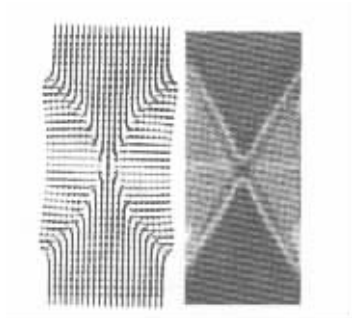
图 4 固体速度场（左）和位移场（右） Fig.4 Velocity and displacement of solid
