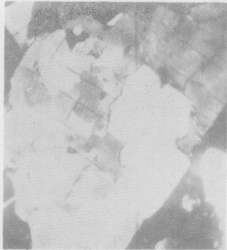
2. 透长石斑晶波状消光及亚颗粒化, 局部(张裂纹发育处)转化为微斜长石 正交×60
