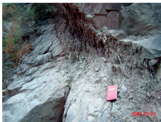
c.库区红色碎屑岩中的软弱夹层(镜向 125°)
