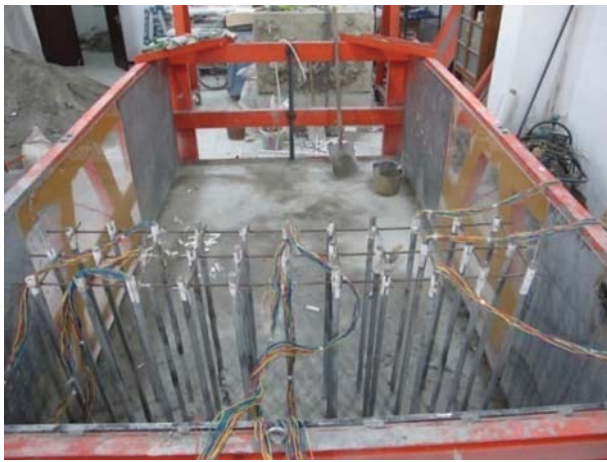
图3 模型箱以及微型桩的布置
