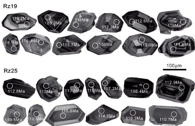
图5 晶洞二长花岗岩中锆石 CL 图像
