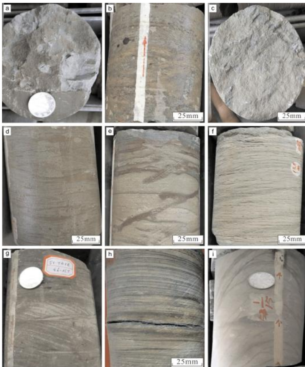
图4 大王庄油田东三段岩心照片
