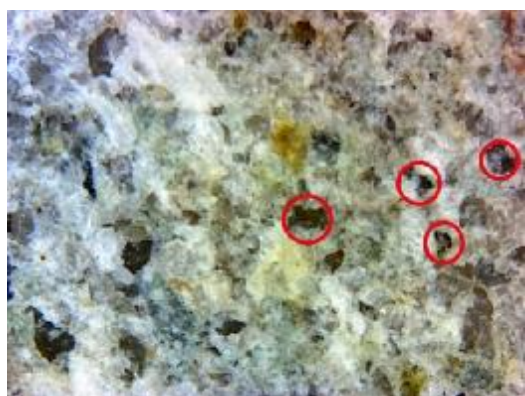
图1 砂岩打磨过程中造成的孔隙
