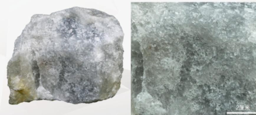
> 我国首条全自动4N8高纯石英砂生产线采用的国产脉石英A级矿样品（左）及其局部放大（右）照片
