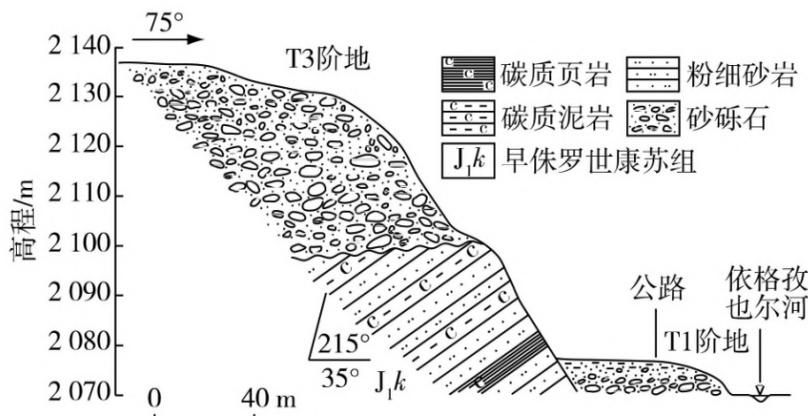
图 4 克孜勒陶乡河流阶地实测剖面图
