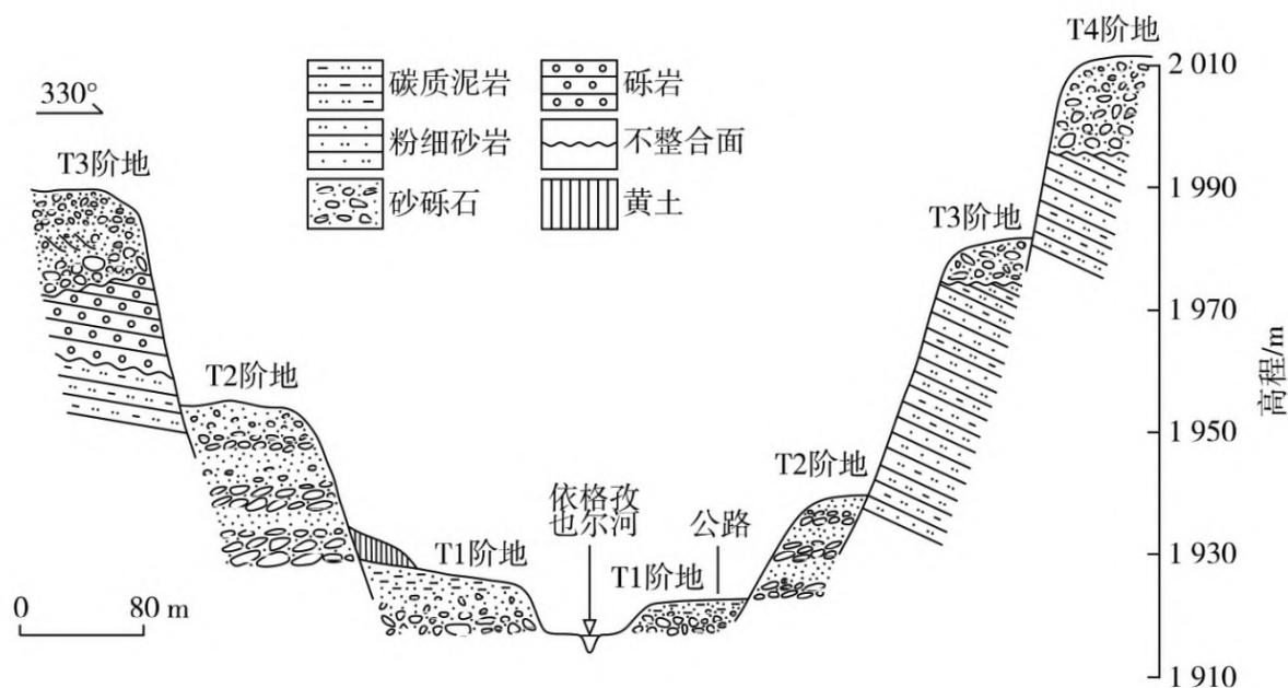
图5 喀尔乌勒村河流阶地实测剖面图
