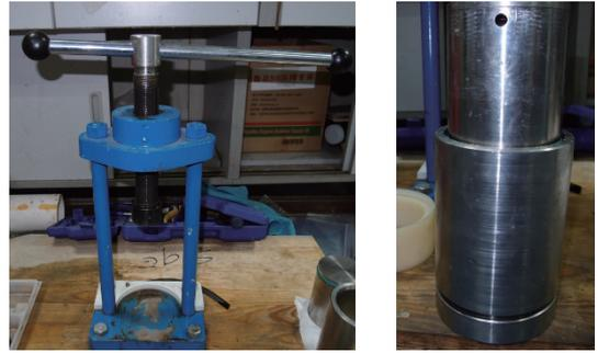
图 10 沉积物孔隙水压榨机
