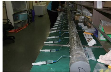
图 11 抽虑法提取孔隙水
