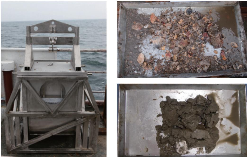
图 2 表层取样器及其在水合物赋存区采集到的表层样品
