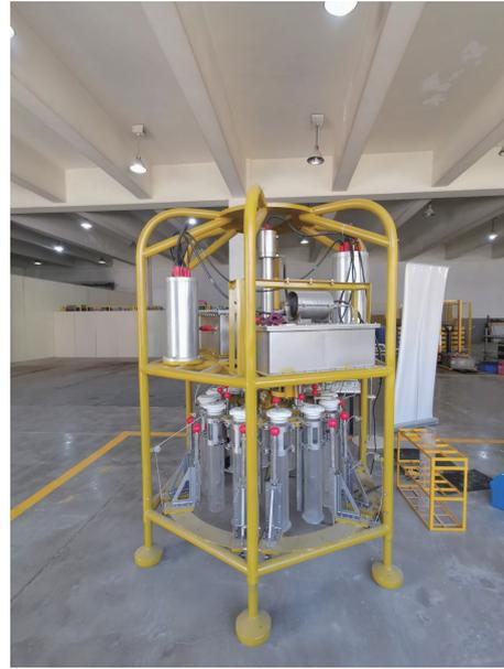
图4 多管取样器
