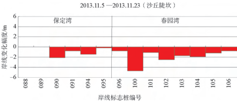
图 11 台风作用下的陡坎变化信息 Fig.11 The erosion scarps change after typhoon
