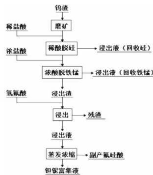
图3 钨渣酸法回收钼铌工艺流程
