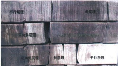
图4 东河塘组前滨中的双向斜层理、平行层理及斜层理
