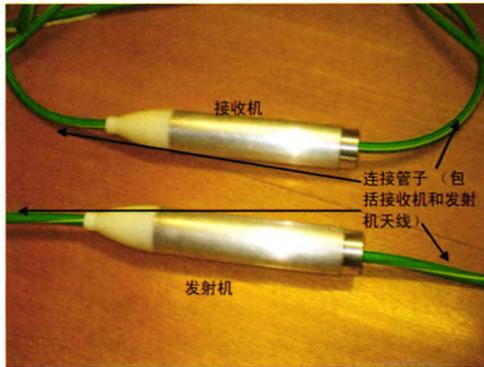
图 1 Groundvue 6 低频探地雷达发射机和接收机
