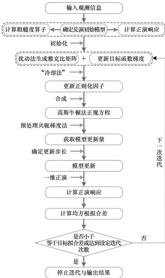
图2 一维最小构造反演流程
