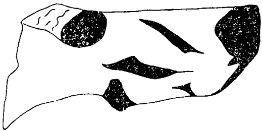
↑ 图3 被菱铁矿交代的珊瑚灰岩 黑色—菱铁矿 无色—泥质物 ← 图2 柴马山二坑矿体南界的灰岩残留体
