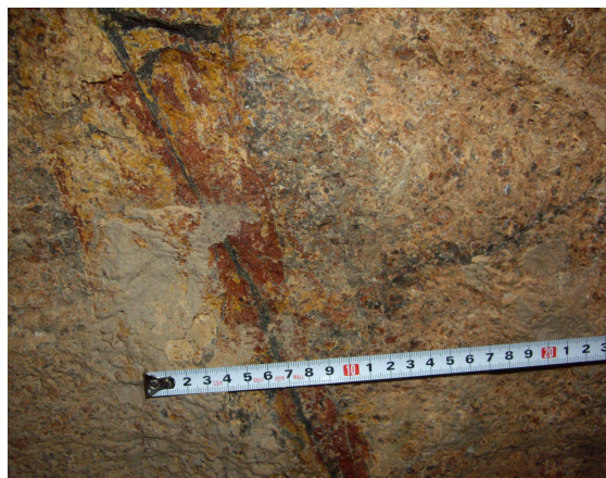
图 6 平巷道中的赤铁矿化沿笔直的裂缝向两侧发育, 中间细脉状沥青铀矿
