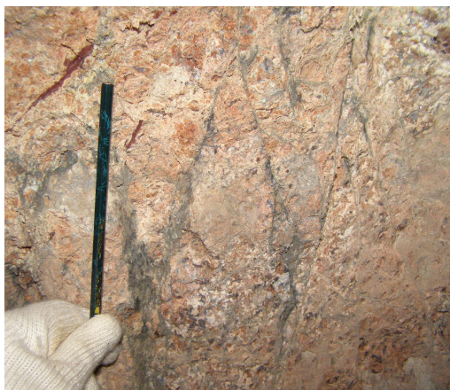
图 7 巷道中沥青铀矿沿构造裂隙成“X”状相交, 近矿蚀变为赤铁矿化
