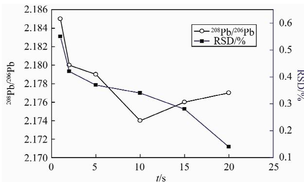
图1 驻留时间对测定 Pb 同位素精密度影响
