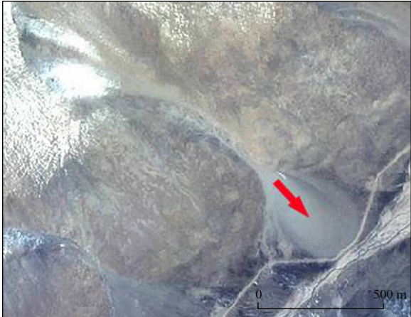
图7 岩屑流卫星图像(箭头位置) (GF-1 B4(R) B3(G) B2(B) 假彩色合成图像)
