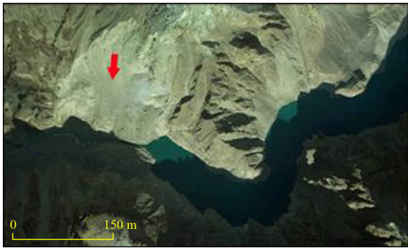
图5 峡谷地带滑坡(红色箭头处)堵塞河道 形成堰塞湖 (Google Earth 影像)
