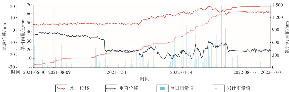
图 6 湾里滑坡 GNSS-2 位移降雨综合分析曲线(2021 年 7 月—2022 年 10 月)
