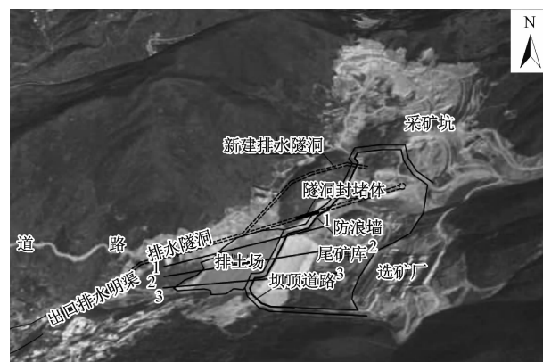
图1 尾矿坝-排土场相互位置关系示意图
