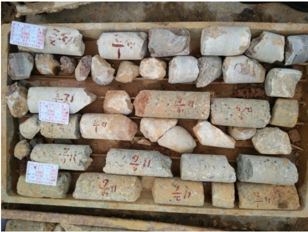
图 6 8#桩检查孔抽芯照片
