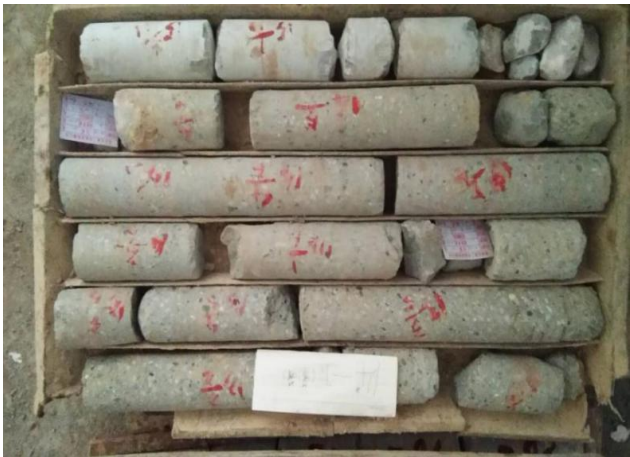
图 7 14#桩检查孔抽芯照片
