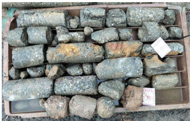
图8 20#桩检查孔抽芯照片
