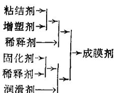
上述溶剂配制前,应先将容器清洗干净后烘干,然后即可按上述配方用天平称好各类化学药品。将各类药品按先后顺序混合在一起时,须用玻璃棒不断搅拌均匀。且由配方制成溶液到喷涂使用之间的放置时间应大于2小时,让固态物质充分溶解。若成膜剂放置时间过长,则稀释剂丙酮有可能会挥发掉,所以再使用时需加丙酮再稀释。
