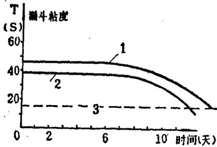
图1 蒟蒻冲洗液粘度降解曲线
