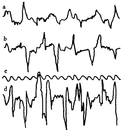
图5 钻柱振动AE波信号波谱图
