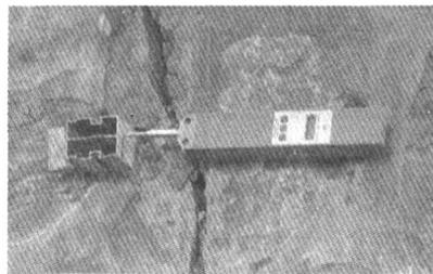
图7 自动裂缝监测计
