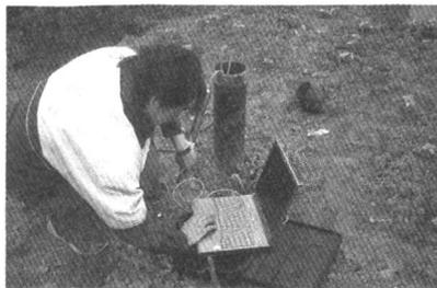
图5 自动存储式水位计
