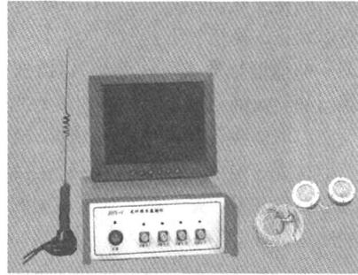
图2 光纤推力监测系统
