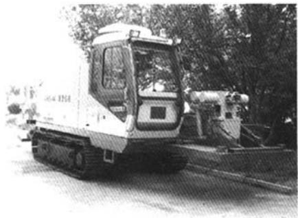
图 1 GBS-40 型铺管钻机主机
