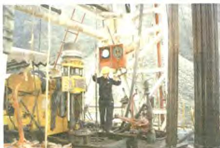
图2 随钻测斜系统
