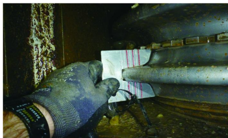
图 3 滚刀磨损检查
