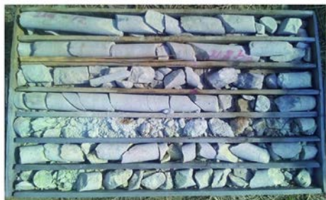
图 4 破碎、坍塌地层岩心图
