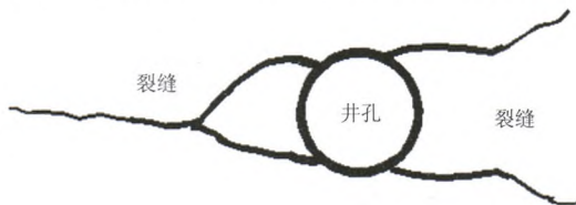
图4 岩石压裂示意图
