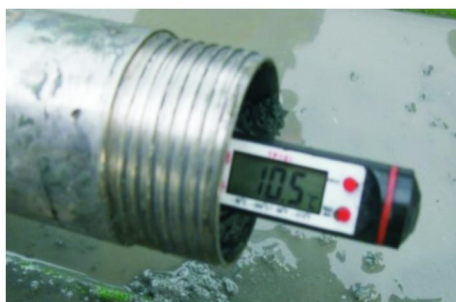
图 13 保温取样筒出井后样品温度
