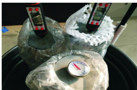
图7 不同取样筒保温性能试验图
