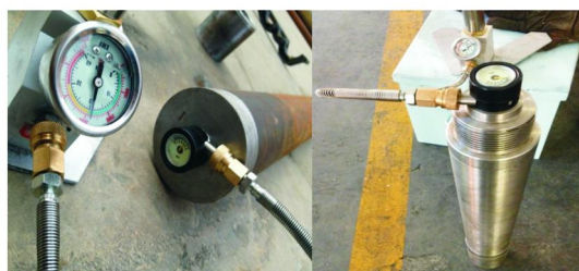
图5 取样器保压机构性能测试图
