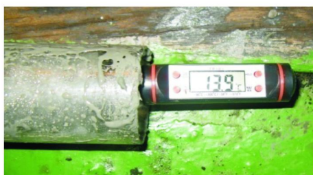
图 14 常规取样筒出井后样品温度
