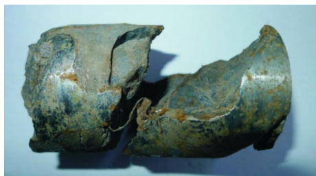
图1 ZK6008孔岩心管与岩心烧至一体
