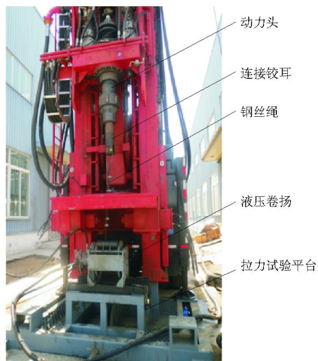
图6 动载稳定性试验
