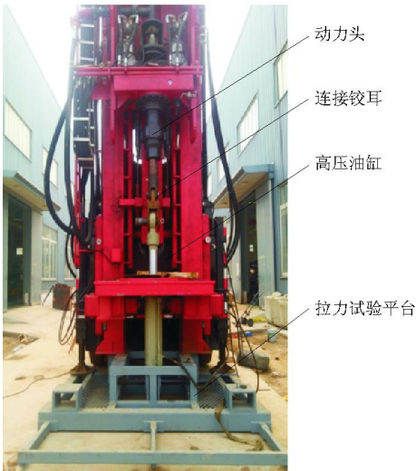
图5 静载负荷试验
