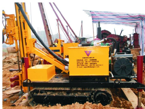
图4 普通回转钻进工艺
