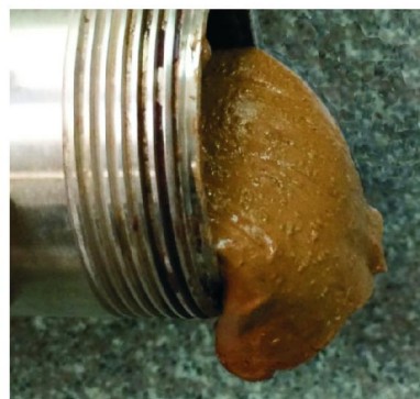
图 6 GN-1 凝胶加重至 1.6 \text{ g/cm}^3 (重晶石加重) 180 ℃ 老化 24 h 后状态
