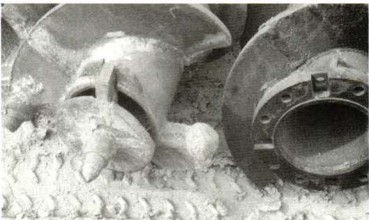
图 2 钻进用长螺旋钻头和厚壁钻杆
