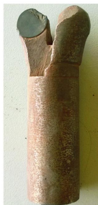
图6 锚杆钻头崩片、保径失效
