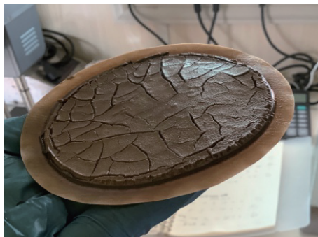
图2 泥饼裂纹多,易掉块
