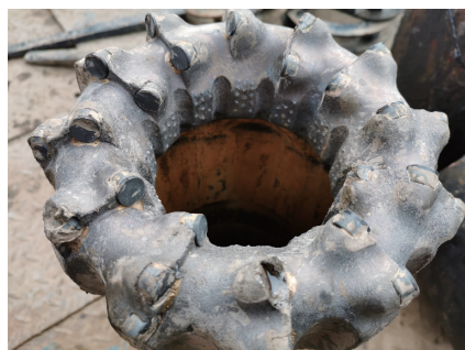
图 5 PDC 钻头切削齿冲击损坏情况
