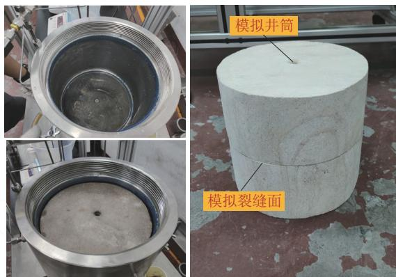
图 4 裂缝模拟原理
